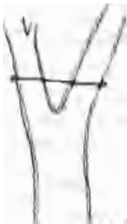
Fig. 11. I stället för järnband böra rundjärn borraras genom stammen och ändarna fästas med muttrar. De bli sedan övervuxna.
