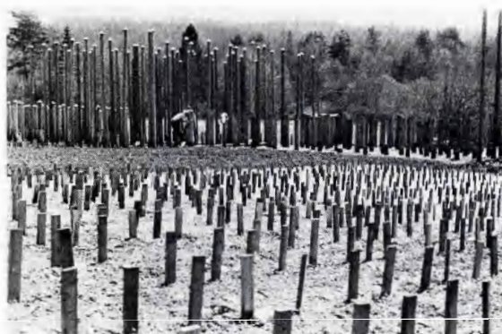
Fig. 1. Interiör från Träskyddskommitténs försöksfält i Simlångsdalen. I förgrunden område med s. k. »stake tests» för standardiserade provningar av tryckimpregneringsmedel. I bakgrunden område för långtidsprovningar av impregnerade stolpar. (Foto: Träskyddskommittén.)
