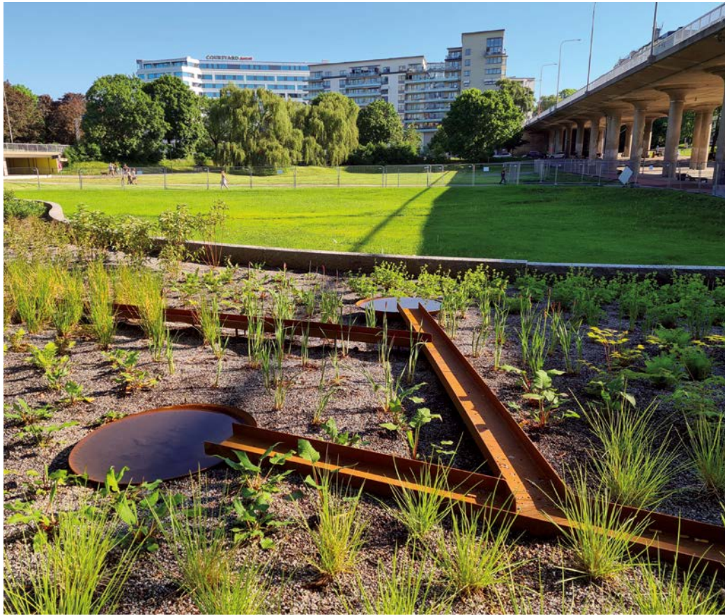
Skyfallsparken i Rålambshovsparken. Vattnets väg genom skyfallsanläggningen är gestaltad med sten i olika bearbetade former, nedsänkta perennplanteringar och skulpterade gräsytor. Stockholmarna får en vacker parkupplevelse med en naturpedagogisk knorr samtidigt som platsen vid behov kan hållas ren och fri från stora mängder regnvatten. Landskapsarkitekt: Urbio.
