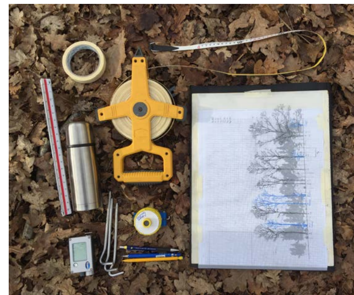
Registreringen måste göras när träden är avlövnade, annars skymmer lövverket trädens arkitektur. Den tidskrävande metoden med ritade profiler kan tyckas ineffektiv, men på foto framträder inte de enskilda trädens karaktär. Utrustningen består av ritfilm, millimeterpapper, mätstav, höjdmätare, måttband, skalstock – och termos!
