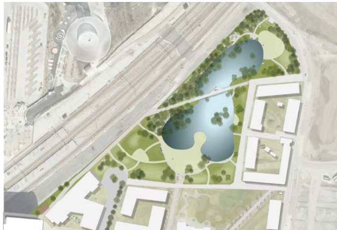
Dagvattenparken vid översvämning efter 50-årsregn. Framför allt vegetationsytor översvämmas. Illustrationsplan Edit Stormwalther, Adobe illustratör, 2020, Malmö stad.
